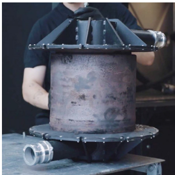
Рисунок 29. Монтаж фитинга на фильтре
