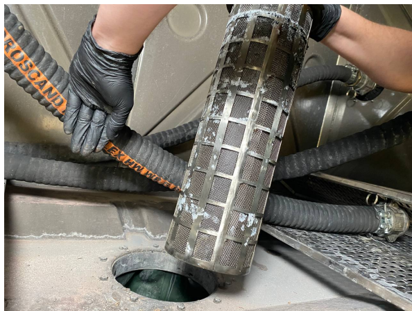
Рисунок 46. Демонтированный фильтр бака
